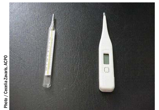
Termomètre traditionnel et son alternative sans mercure
