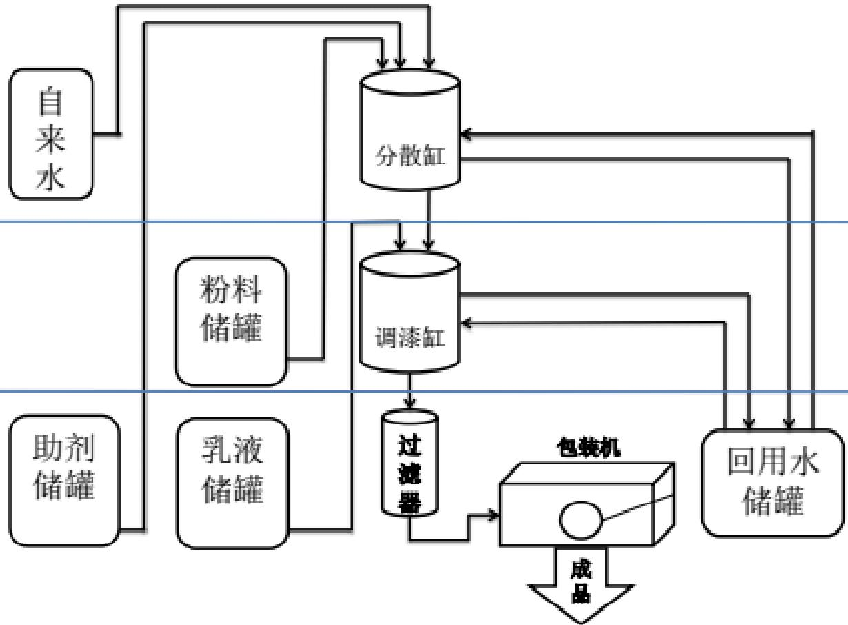
➤ 粉料、乳液、助剂全部采用储罐直接输送的形式进料，杜绝了投料过程造成的包装物、泄露所造成的污染；
