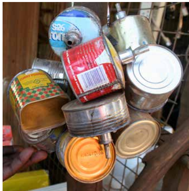
Lámparas de keroseno con mecha fabricadas con latas recicladas
