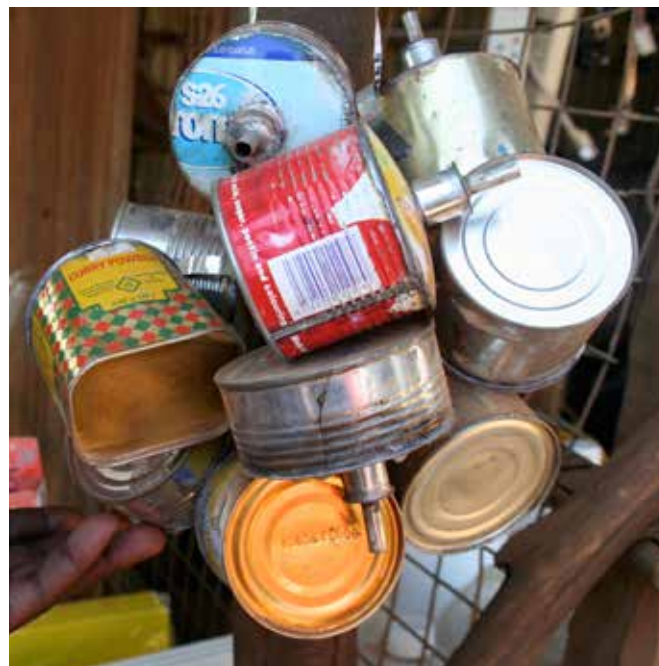
Керосиновые фитильные лампы, изготовленные из утилизированных консервных банок
