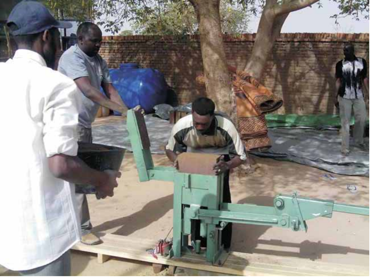
شكل 10: آلة الضغط الخاصة بإنتاج كتل التربة المُعالجة التي يُشجعها برنامج الأمم المتحدة للمستوطنات البشرية في دارفور
