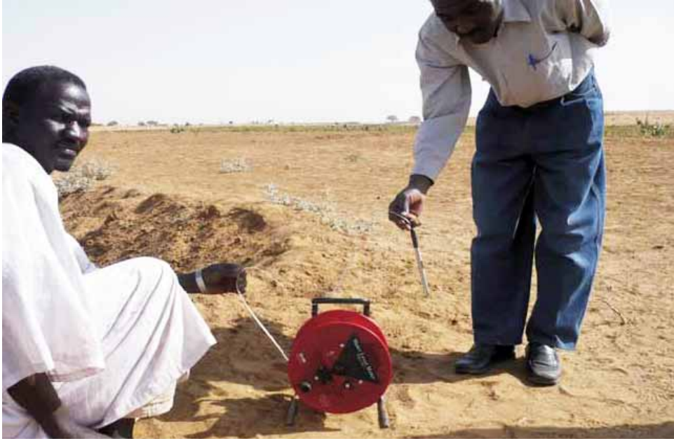
الشكل 8. «جهاز» قياس مستوى الماء يدويًا. يوضع المجس على طرف شريط يُدلى في البئر لقراءة عمق المياه يدويًا.
