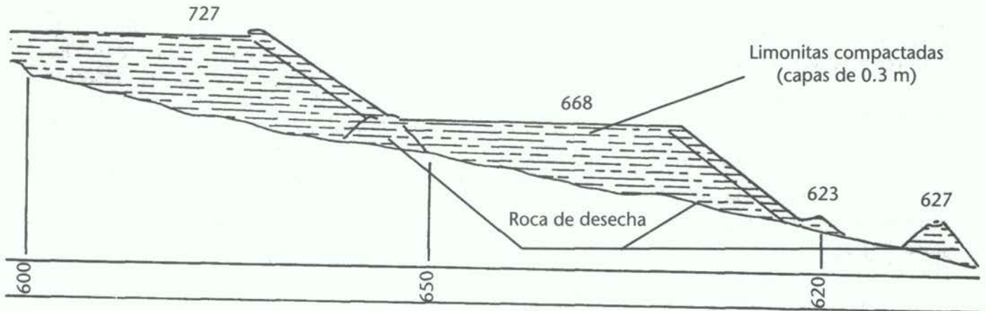
Figura 14. Almacenamiento de Desechos de Limonita en la Mina de Níquel de Kongouhaou (Nueva Caledonia)
