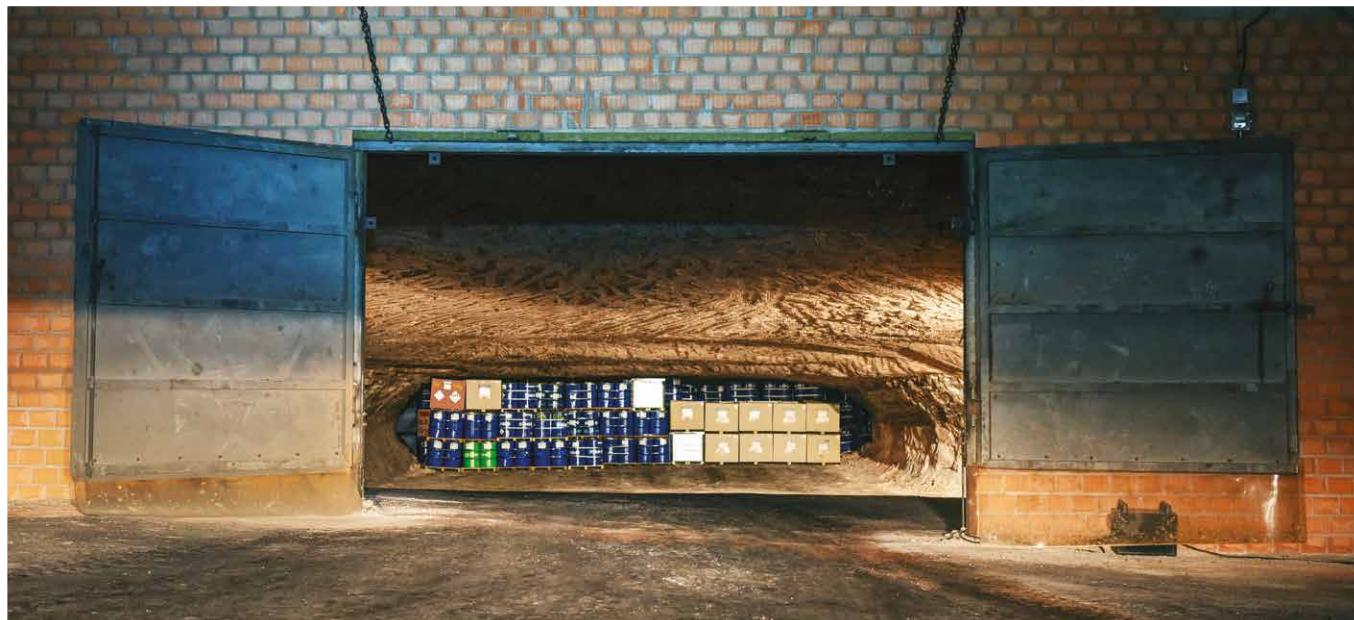
Отсек для удаления отходов, загрязненных ртутью, на подземном объекте © K+S Entsorgung GmbH
