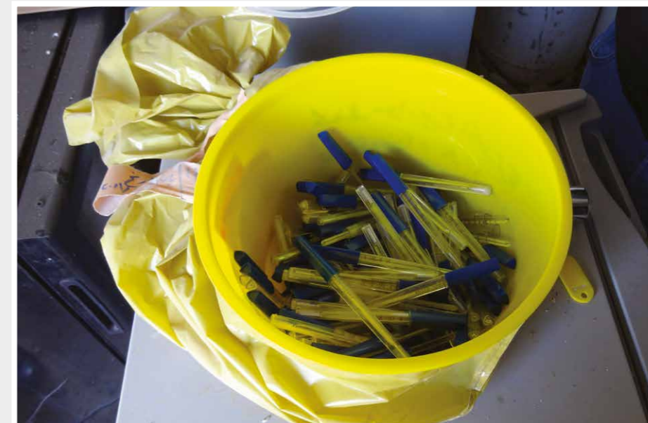
Termómetros que contienen mercurio almacenados en el vertedero de desechos peligrosos de Swaqa © PNUMA
