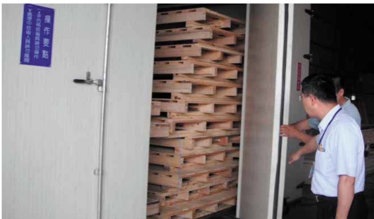
Термообработка деревянных поддонов в Китае.
