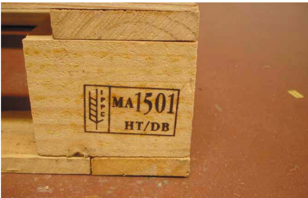
Деревянный поддон из Марокко с требуемой IPPC печатью, указывающей на его термообработку.
