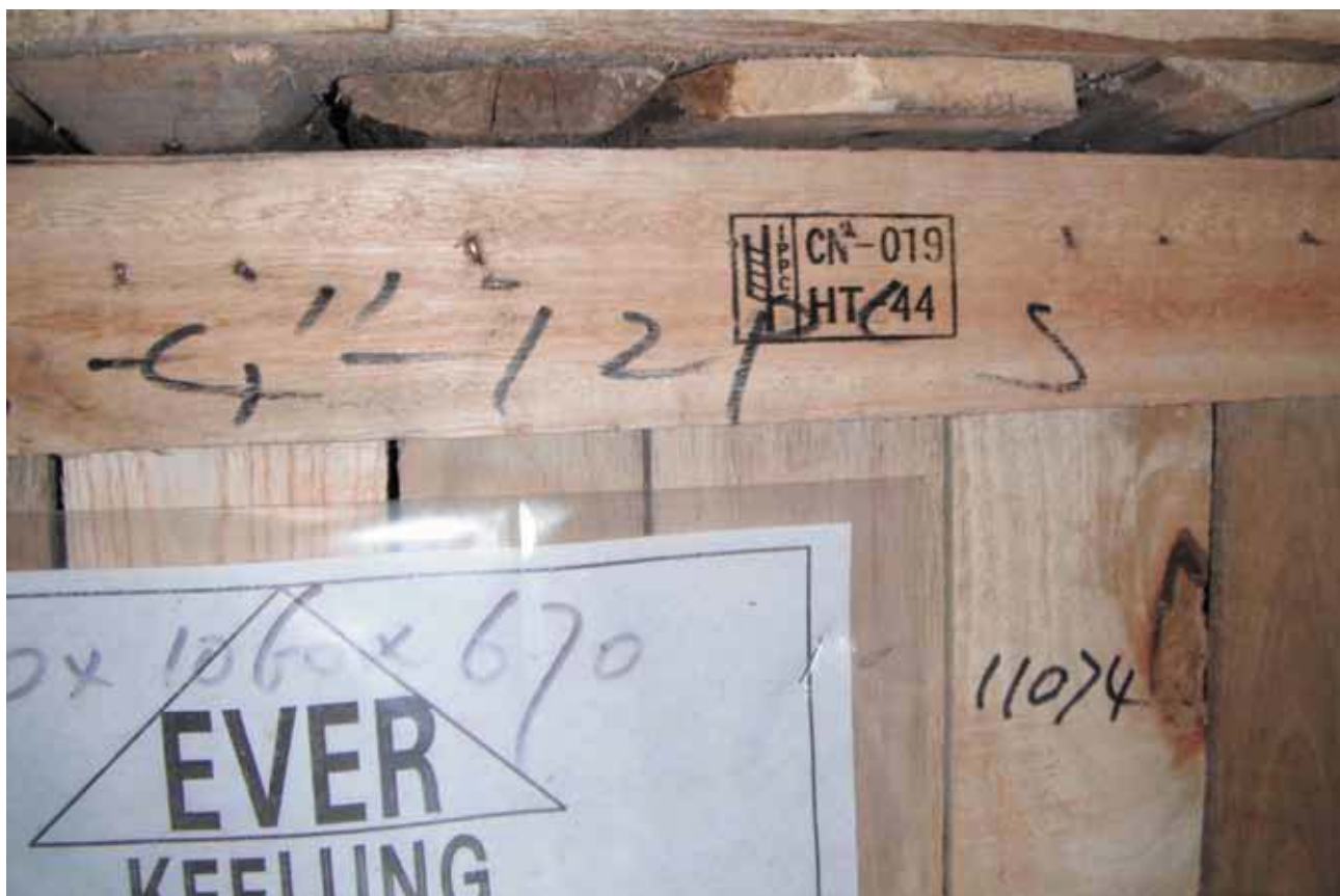
Деревянные поддоны из Китая, демонстрирующие IPPC печать о термообработке согласно ISPM-15.
