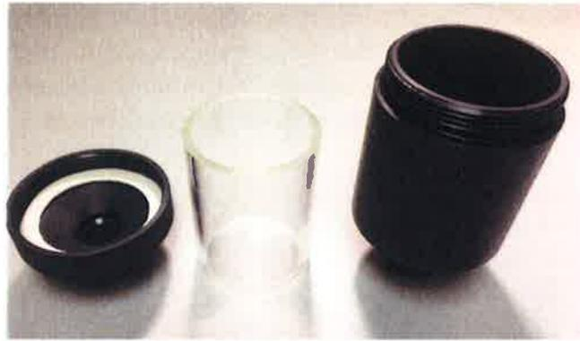
Los adsorbentes pueden variar en función de los analitos a recolectar: espumas de poliuretano (PUF), resinas poliméricas (como por ejemplo, amberlitas) o carbón activo. Los adsorbentes ubicados en el módulo porta-adsorbentes atrapan la fracción gaseosa de la muestra de aire. En este procedimiento se emplea la combinación de 2 PUF (de diferente tamaño) y resina polimérica XAD-2, colocados en el interior de una camisa de vidrio.
