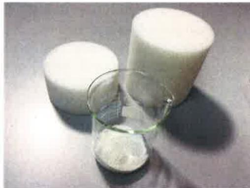
La preparación del módulo porta-adsorbentes se inicia tomando la camisa de vidrio y, preferentemente por la parte inferior se coloca el PUF de menor tamaño. Seguidamente se añaden 10 g de la resina polimérica (XAD-2) y finalmente se coloca encima el PUF de mayor tamaño.
