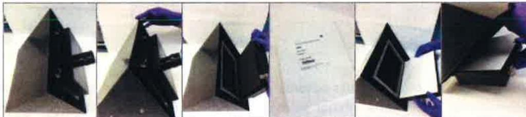
*NOTA: Es importante evitar posibles episodios de contaminación, por ello los analistas han de utilizar guantes durante la colocación del filtro en el módulo. También se pueden utilizar un par de pinzas para colocar bien el filtro en el soporte. Además se deben evitar zonas de trabajo polvorientas y/o sucias.*
