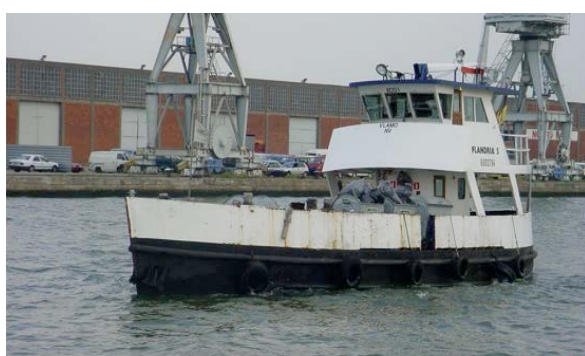
Barge de collecte des ordures uniquement (Crédits photographiques : Vlamo, Anvers, Belgique)
