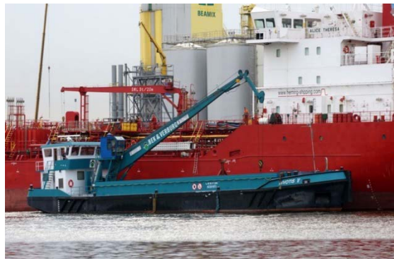
Barge de collecte dans le port de Rotterdam (Pays-Bas) (Crédits photographiques : port de Rotterdam)
