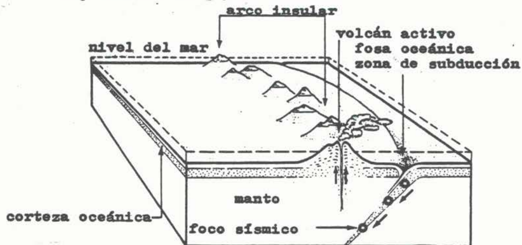
Figura 2.21 Diagrama esquemático de la zona de subducción y del arco insular volcánico resultante.
