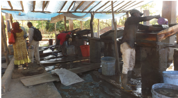
Concentration du minerai par le système d'écluse
