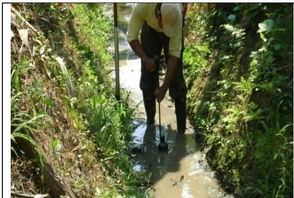
Toma de muestra de aumento de nivel en canales de drenaje para detección de residuos de plaguicidas.
