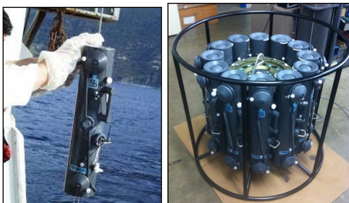
Figure 1. Échantillonneur d'eau de mer individuel GO FLO et système de rosette avec plusieurs échantillonneurs
