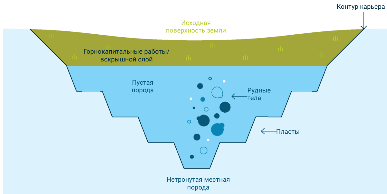
Рисунок 2.2 Упрощенный поперечный разрез карьера, на котором показаны общая выработанная зона (все, что находится в пределах контура карьера), зона предварительной вскрыши, а также скаты эксплуатационного уровня, содержащие как пустую породу, так и целевую металлическую руду.
