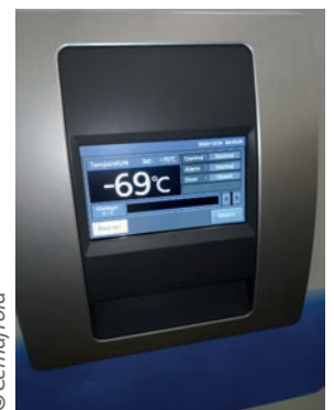
Fig. n° 10 a) : Armario refrigerado para el almacenamiento de vacunas en el hospital Fig. n° 10 b) : Panel de control
