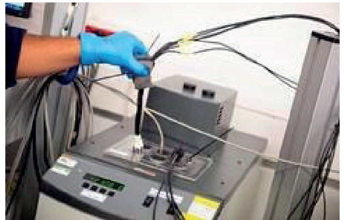
Fig. n°12: Verificación metroológica de un registrador de temperatura con sonda externa
