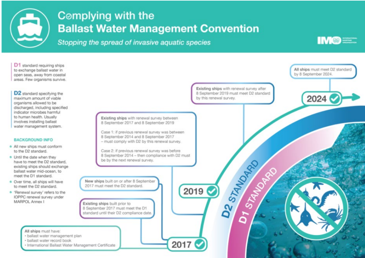
الشكل 3: الانتقال من المعيار د-1 إلى المعيار د-2 في إدارة مياه الصابورة (المصدر: المنظمة البحرية الدولية)
