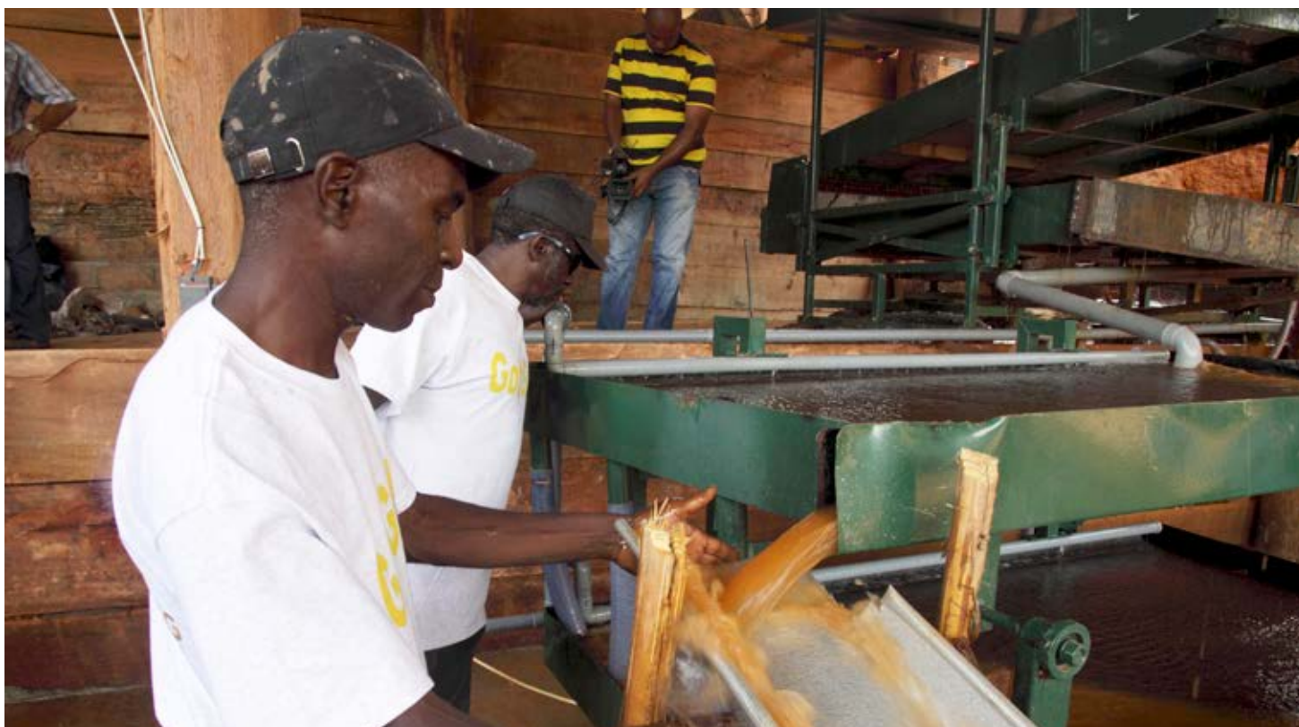
Золотодобытчик испытывает «безртутный» «встряивающий стол» для извлечения золота на руднике Аква Азул в округе Сарамакка (Суринам). Фото: Рану Абхелах/Рейтер
