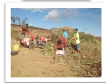
Machine pour découper les matières premières dans la fabrication de compost par GPS Ambinintsoa Ampasikely sur tanety
