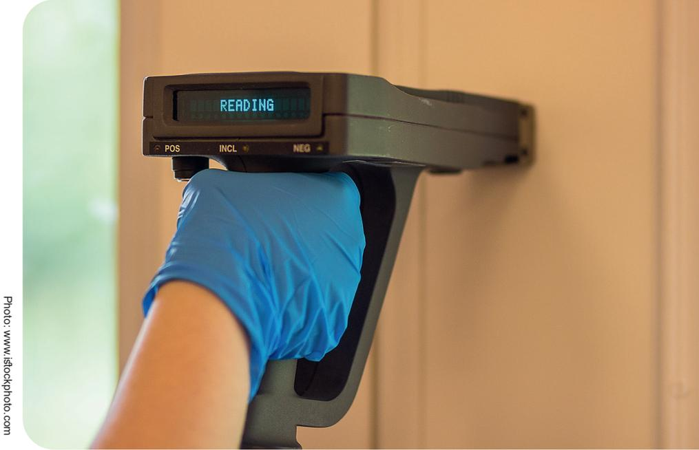
توجد طرق تحليلية مختلفة لقياس الرصاص في الطلاء. يقدم دليل منظمة الصحة العالمية الموجز للطرق التحليلية لقياس الرصاص في الطلاء نظرة عامة على الطرق الرئيسية، بما في ذلك الطرق المخبرية، وقياس طيف الأشعة السينية الثانوية بالأجهزة الثابتة أو المحمولة (XRF)، وتحليل الطيف الضوئي (منظمة الصحة العالمية، 2020).
