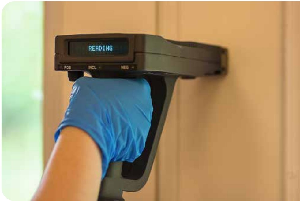
► 图 4 - 用 X 射线荧光分析仪检查含铅涂料
