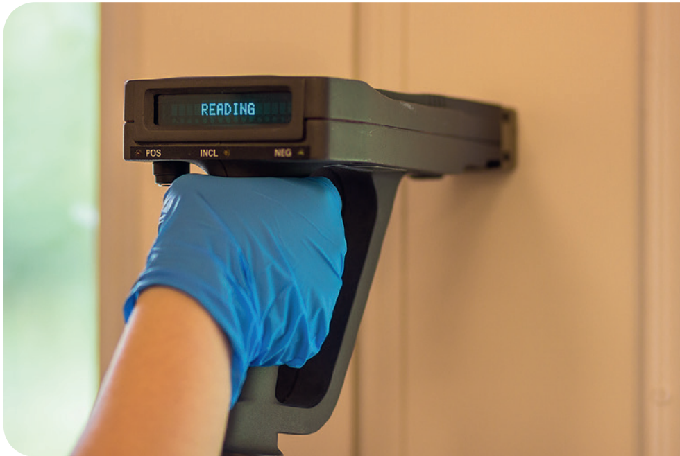
► Figure 4 – Inspection d’une peinture au plomb au moyen d’un analyseur de spectrométrie de fluorescence X
