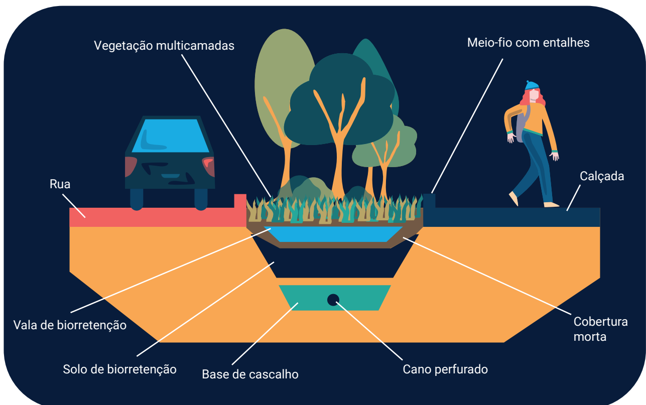
Figura 2: Vala de biorretenção urbana
