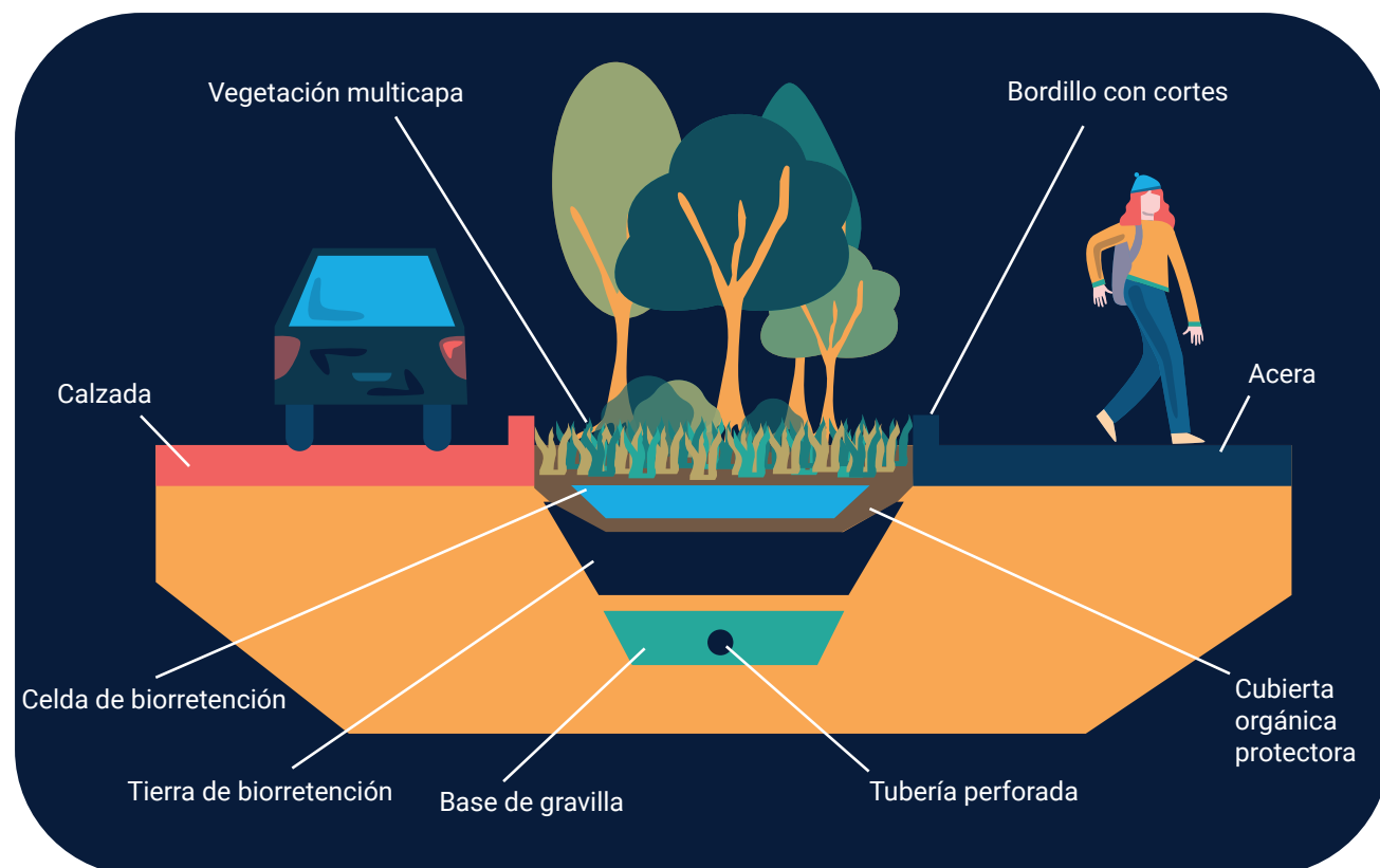
Figura 2: Celda de biorretención en zona urbana
