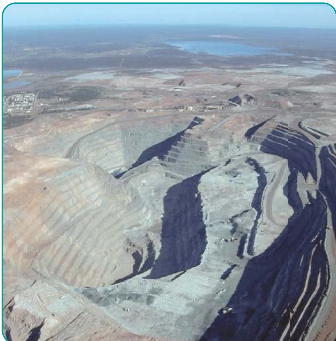
Fig. 5: La mine d'or de Kalgoorlie La "super carrière" de Kalgoorlie est la plus grande mine d'or d'Australie avec 4 km de long, 1.5 de large et 500 m de profondeur. Le 30 janvier 2004, le Gouvernement d'Australie Occidentale a confirmé des fuites de cyanure en provenance des digues de rétentions vers les eaux souterraines environnantes, ce que les communautés de riverains suspectaient depuis presque 10 ans.
