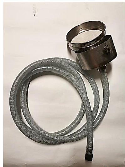
Figure 193 : Un tuyau en PVC doté d'un système de filtration avec un tamis en acier inoxydable (100 µm) (© IWRS, 2022).
