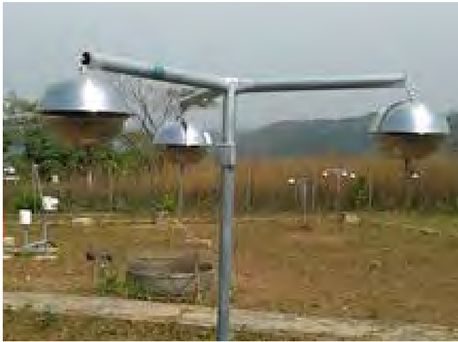
Sampling site for air with PAS/PUF: Togo, © Direction des Laboratoires/ Laboratoire de Contrôle Qualité et de Normalisation
