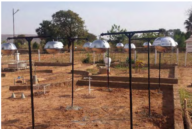
Sampling site for air with PAS/PUF: Mali, © Ministère de l'Environnement, de l'Assainissement et du Développement Durable
