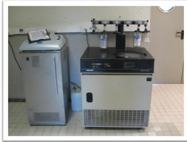
Dispositivo de laboratorio para liofilización
