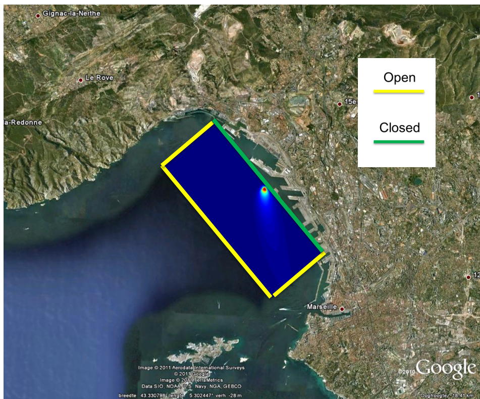
Figure 3.1 Vue d'en haut d'une représentation rectangulaire simplifiée d'un environnement "ouvert"; exemple d'un environnement "ouvert" pour le Golfe du Lion (Deltares, 2012)
