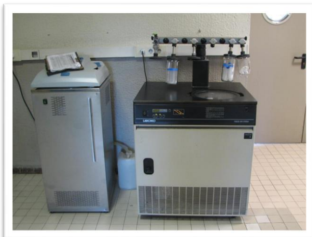
Appareil de laboratoire pour la lyophilisation
