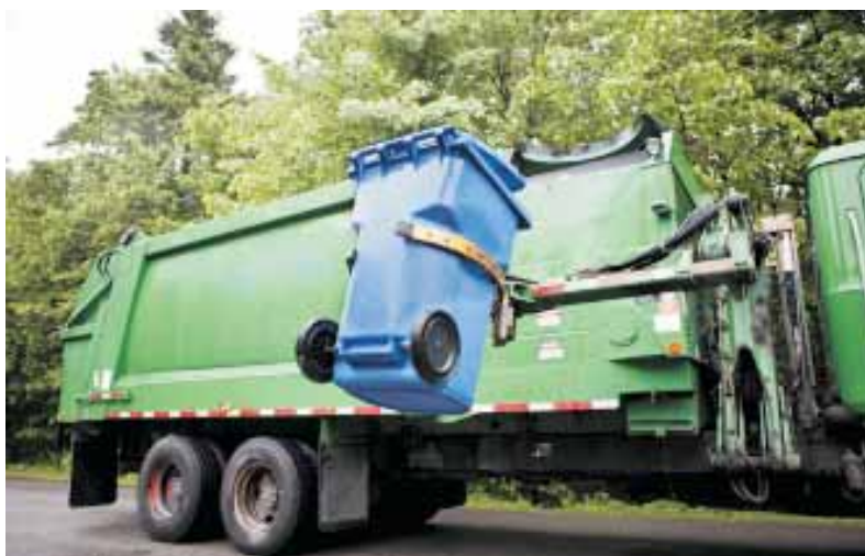
Camión municipal con un brazo robótico que recolecta los desechos domésticos para su reciclaje. © Paul Vasarhelyi/iStock
