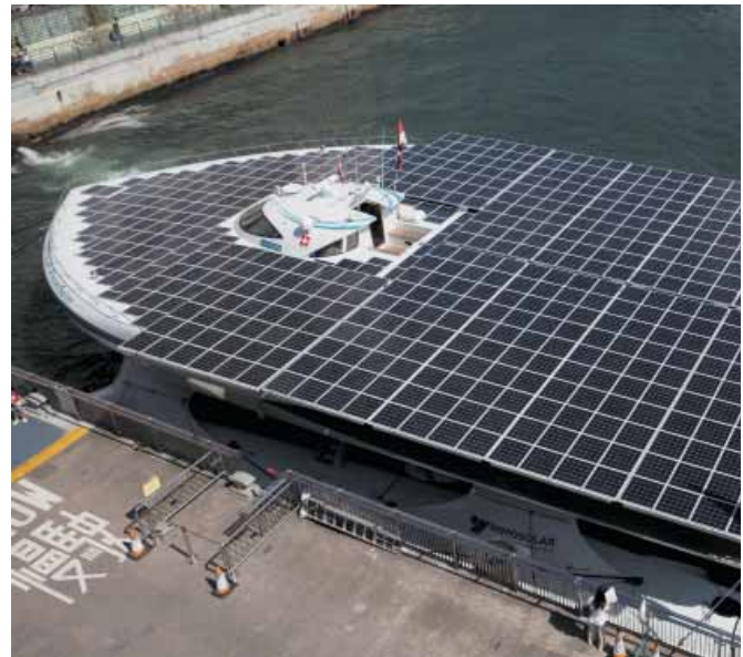
Turanor PlanetSolar, el más grande barco del mundo impulsado por energíasolar –cubierto con 500 m2 de paneles solares- fue el primer vehículo eléctricosolar en dar la vuelta al mundo. © Tatiana Kakhill/iStock
