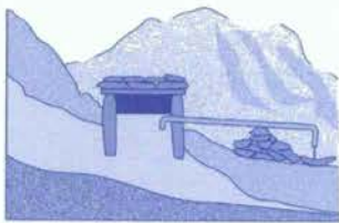
Sistema tradicional Afalaj para extraer agua de acuíferos poco profundos, que se utilizaba corrientemente en Asia Occidental y limitaba las extracciones a límites seguros
