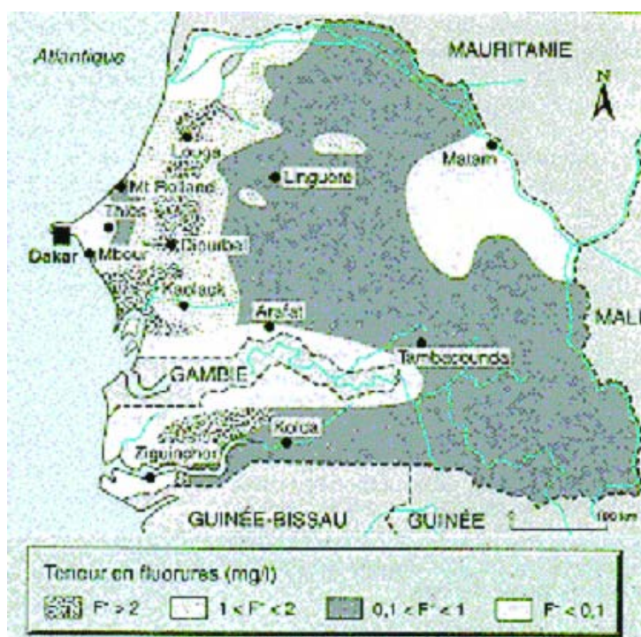
Figure 14 : Carte des teneurs en ions fluorure de la nappe du Maestrichtien (Travi Y. 1988)
